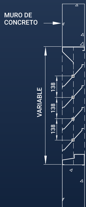
INSTALACIÓN EN MURO DE CONCRETO
